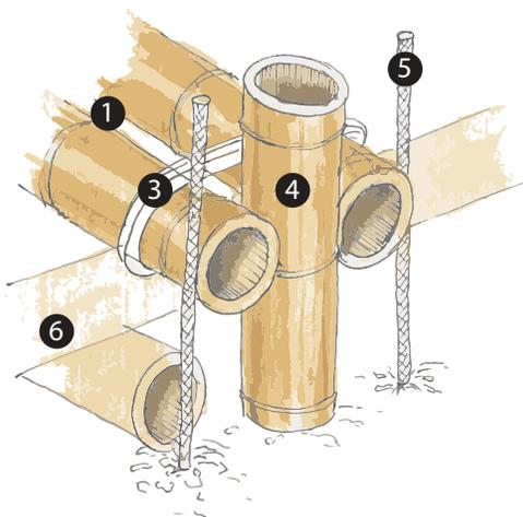
Figura 12. Detalle 1, fijación de columnas laterales
